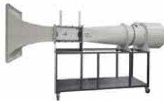
Şekil 3.1: Deneysel çalışmalarda kullanılan TQ AF100 model ses altı rüzgâr tüneli
